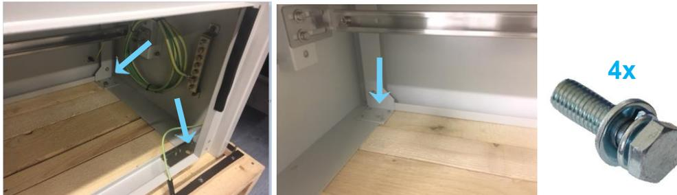
Bild 11: Vordere und hintere Befestigungspunkte des MFG
